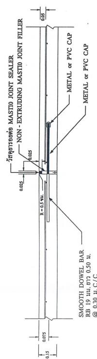
รูปแบบรอยต่อ EXPANSION JOINT (ทุกราบบีบ 100 เมตร)
